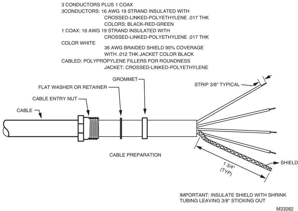
**Fig. 3. Connector wiring.**
